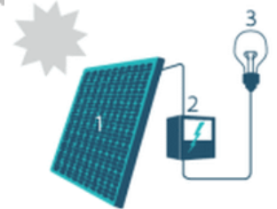
1. Zonnepaneel | 2. Omvormer | 3. Elektrische toestellen
